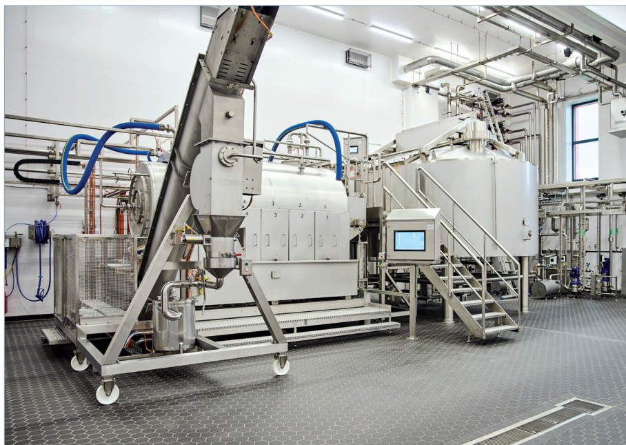
Käsefertiger, Entmolkungstrommel, Absackung (Bildnachweis: Käserei H. Birkenstock GmbH)
